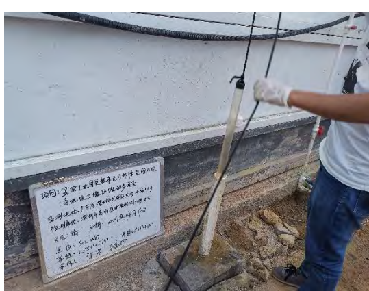
W2监测井采样前洗井
