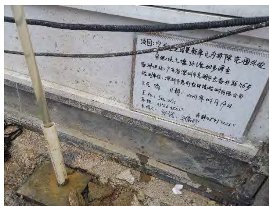
W1监测井采样前洗井
