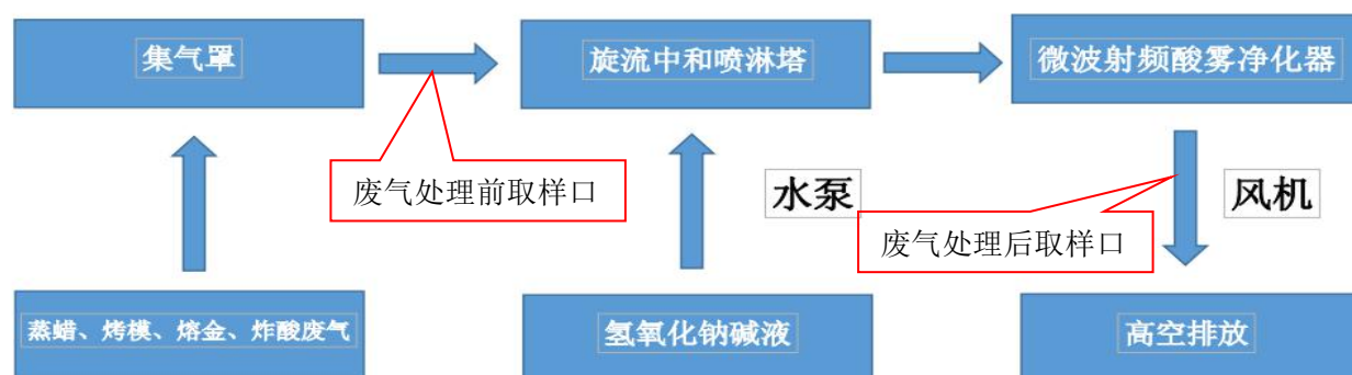
图 3-2 废气处理工艺流程图
